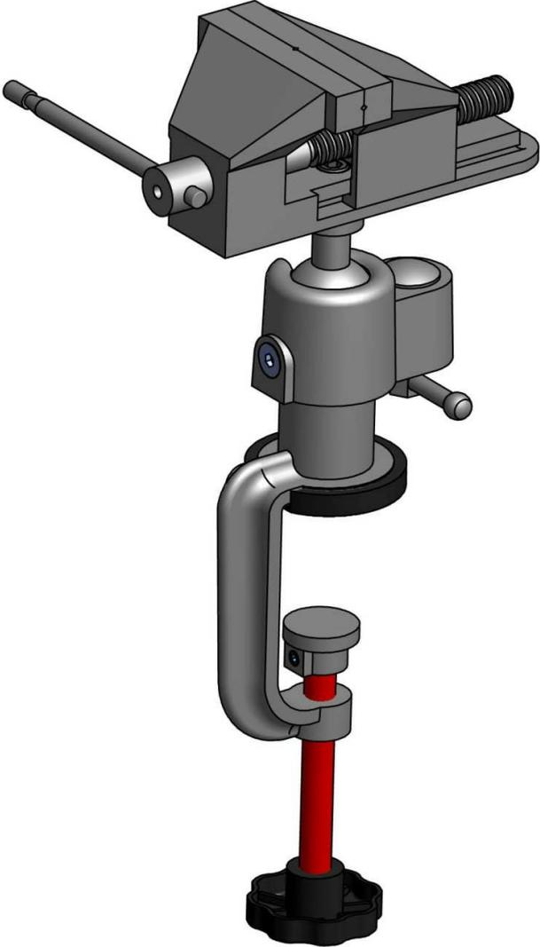
1 Beweglicher Backen; 2 Fester Backen; 3 Knebel lang; 4 Spindel; 5 Knebel kurz; 6 Klemmschraube; 7 Druckscheibe; 8 Tischklemme
