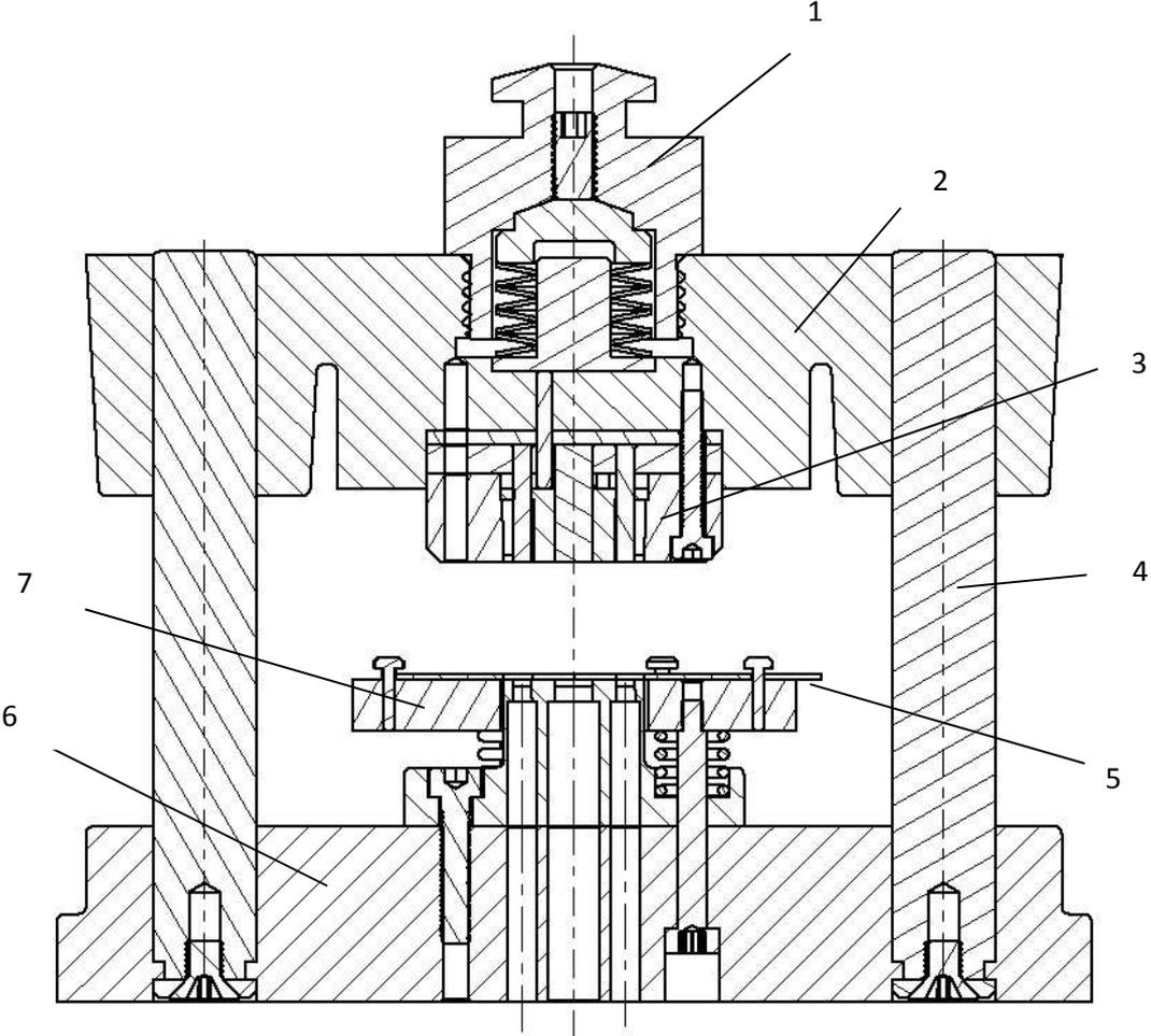
1 Einspannzapfen; 2 Gestell oben Kopfplatte ; 3 Auswerfer oben ; 4 Führungssäule; 5 Werkstoffstreifen ; 6 Grundplatte; 7 Auswerfer für Seitenführung;
