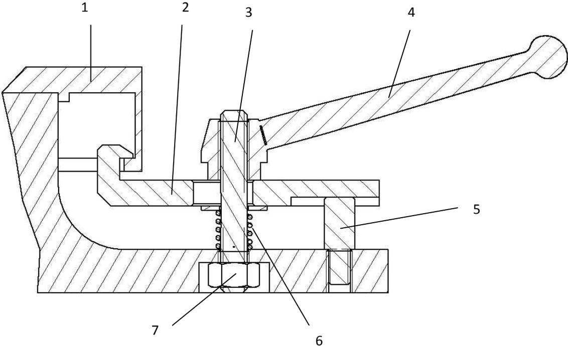
1 Werkstück; 2 Spanneisen innen; 3 Spannschraube; 4 Spannhebel;
