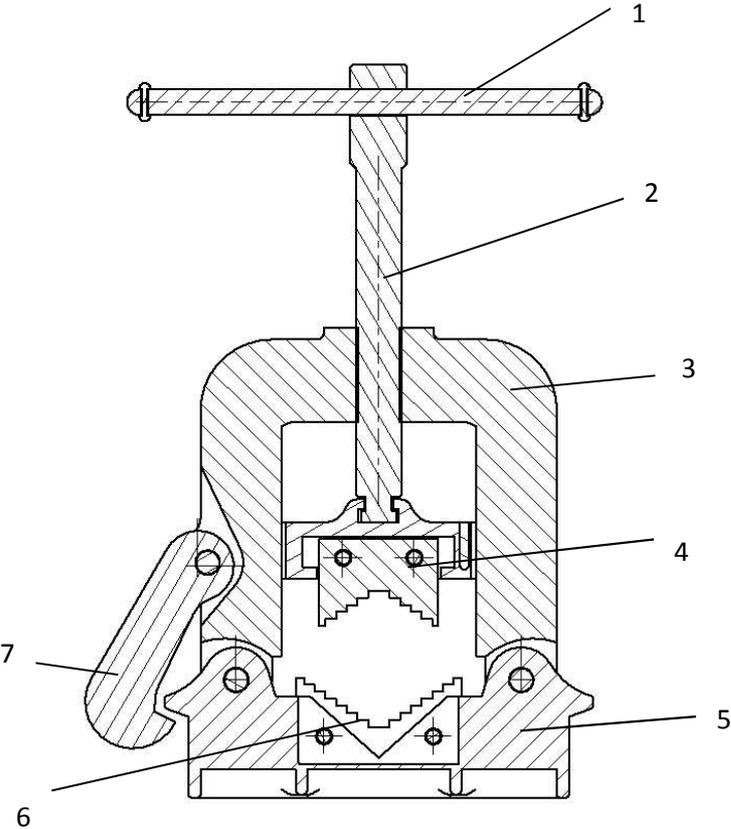
1 Spannhebel; 2 Spindelschraube; 3 Gestellbügel;
