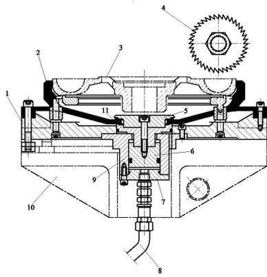
**Bild 6-50 Fräsvorrichtung für hartgelötetes Blechteil**
