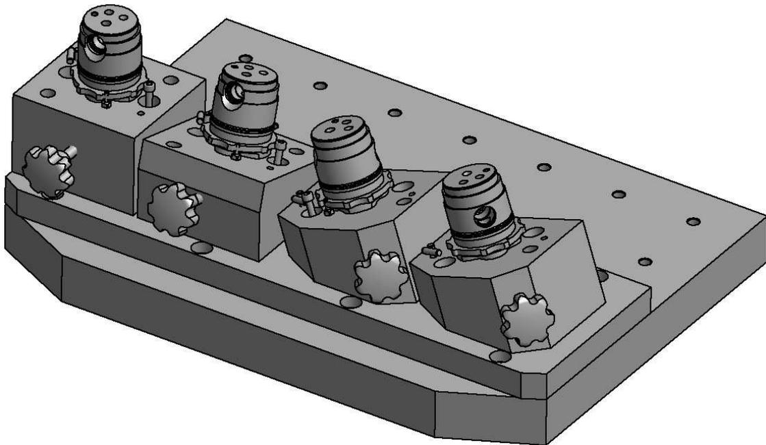
**Bild 7-38 Spannvorrichtung für 4 verschiedene Arbeitsfolgen**
