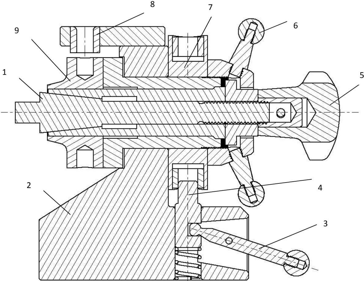
1 Werkstückaufnahme; 2 Aufnahme; 3 Hebel für Verriegelung; 4 Index Bolzen; 5 Handrad; 6 Hebel für Lochteilung; 7 Teilscheibe; 8 Bundbohrbuchse; 9 Werkstück
