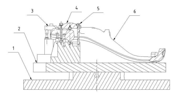
Bild 7-42 Mechanische Spannvorrichtung für Querlenker
