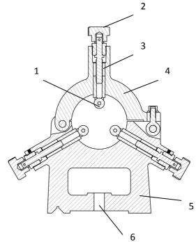
Mitgehender Setzstock 1 Stellrad; 2 Pinole; 3 Grundkörper; 3 Fixierbacken; 4 Spannpratzen Befestigung
