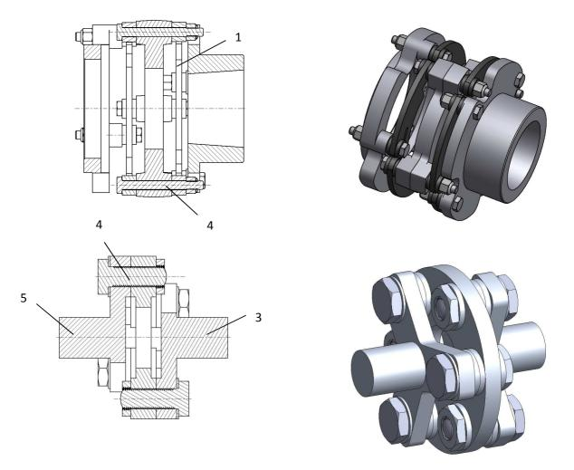
Elastische Kupplungen sind steckbar und einfach zu montieren. Das Elastomerelement gleicht den Wellenversatz und nimmt moderate Stöße von Motor oder Arbeitsmaschine auf. Vorteil: zuverlässige Kraftübertragung bei Wellenversatz mit geringen Rückstellkräften.
