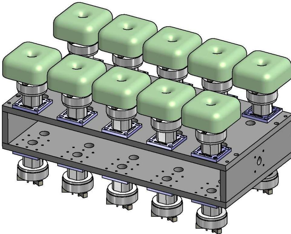
**Bild 8-27 Pneumatisches Backenfutter für CNC Bestückung**
