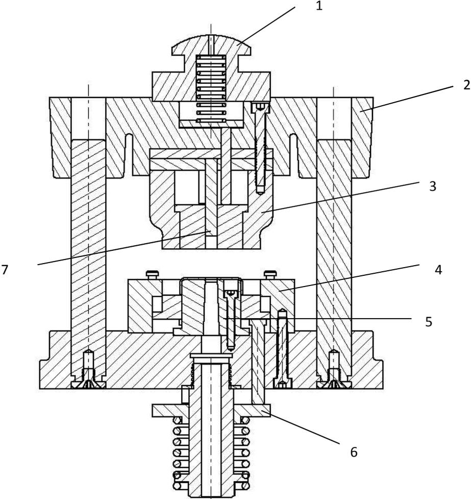
1 Einspannzapfen; 2 Kopfplatte; 3 Schneid und Ziehstempel oben;
