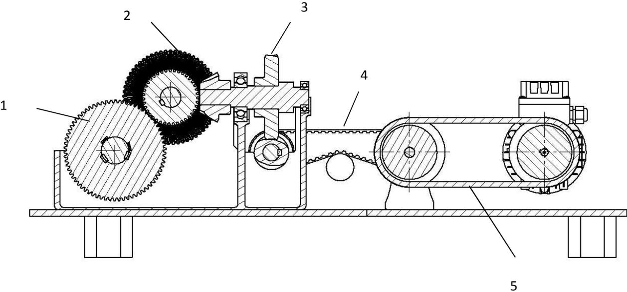
1 Zahnrad; 2 Kegelrad; 3 Schneckenrad; 4 Zahnriemen; 5 Keilriemen;
