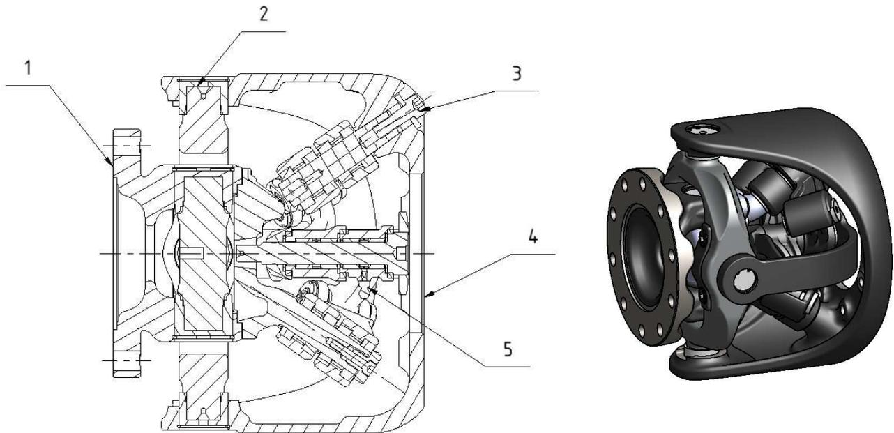
**Bild 12-14 Wellenkupplung mit bis zu 15 Grad Gelenkwinkel**
