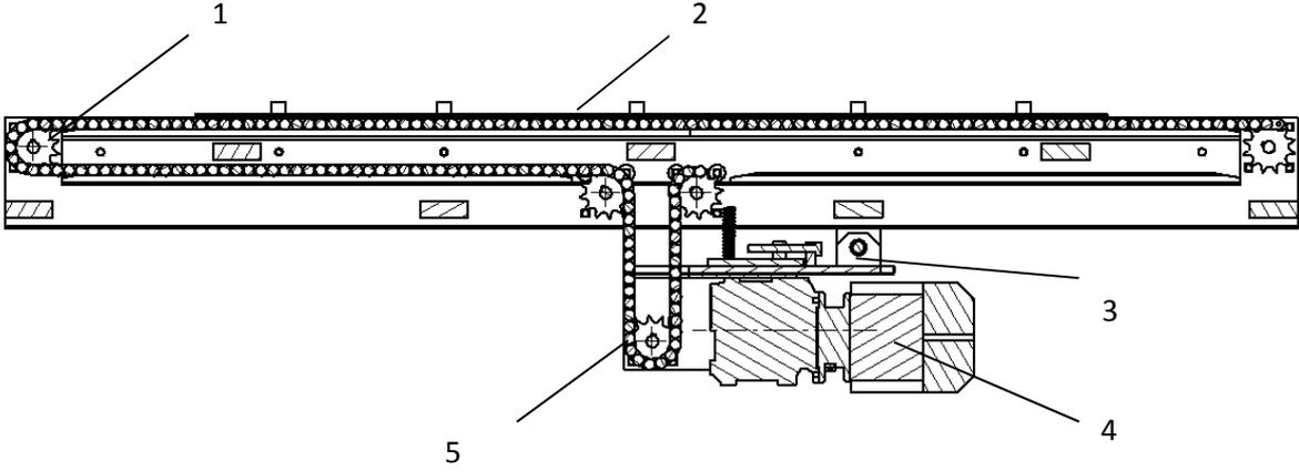
1 Kettenumlenkrolle; 2 Transportrollen; 3 Motorbefestigung 4 Antriebsmotor; 5 Umlenkrolle;
