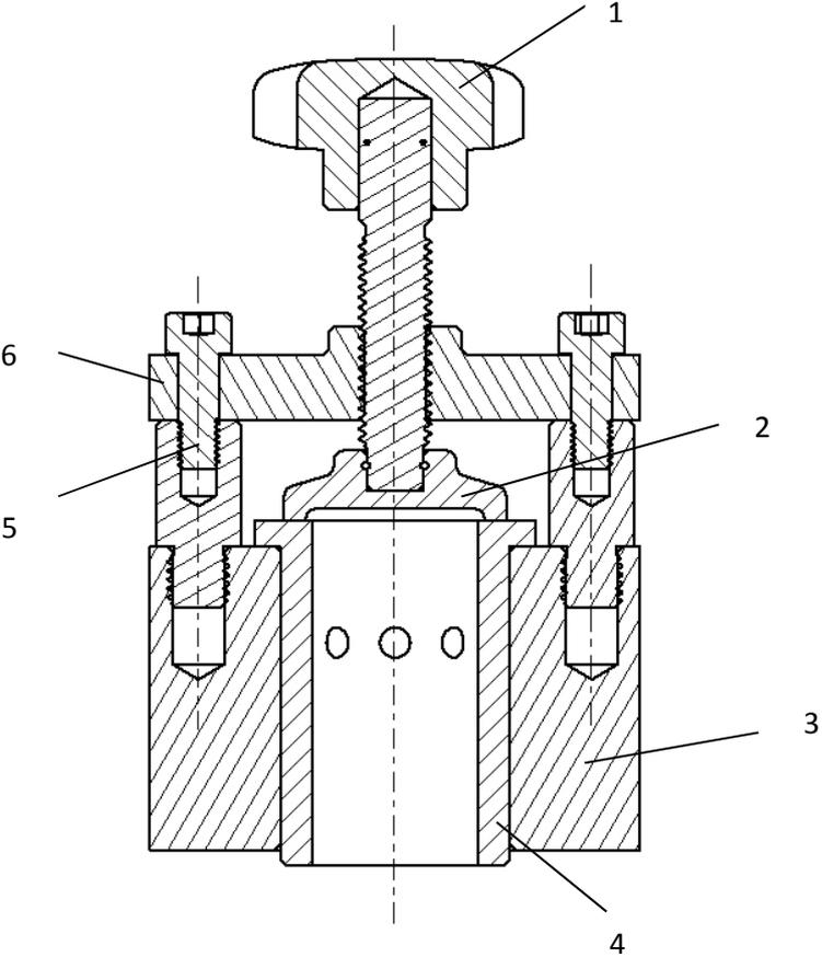
1 Kreuzgriff; 2 Spannpratze; 3 Grundkörper; 4 Werkstück; 5 Imbusschraube; 6 Stützplatte
