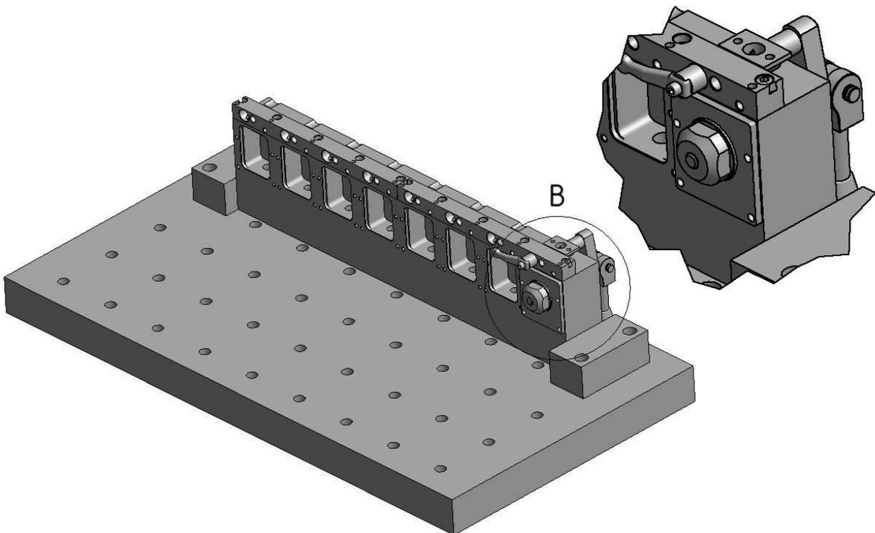
**Bild 7-39 Exzenter Spannvorrichtung 8 fach**
