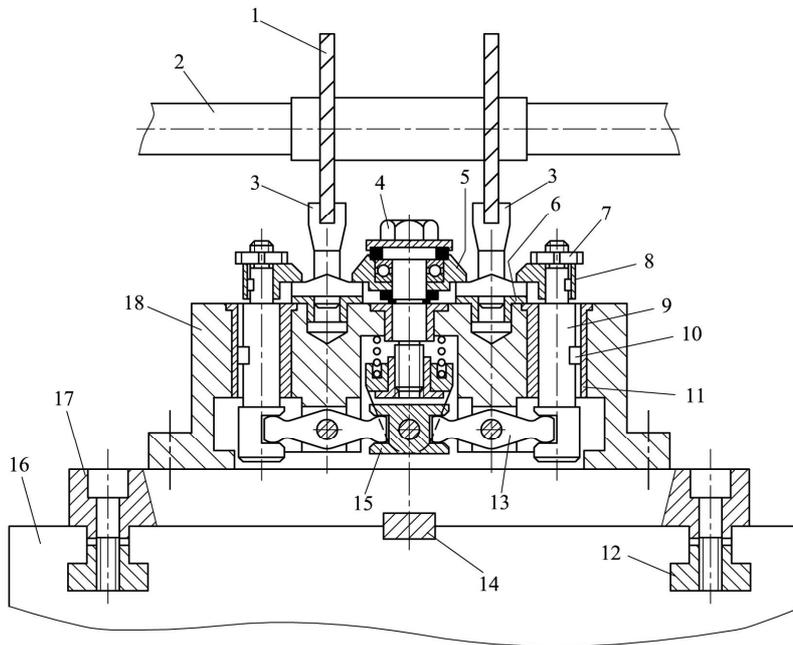
1 Scheibenfräser; 2 Fräserwelle; 3 Werkstück; 4 Spannschraube; 5 Spannscheibe;
