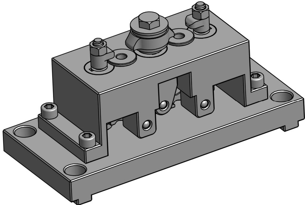
Die Doppelspannvorrichtung zum gleichzeitigen Fräsen von zwei Werkstücken kann zwei Werkstücke durch eine Spannschraube befestigen. Somit ist ein schnelles Wechseln der Werkstücke gegeben.
