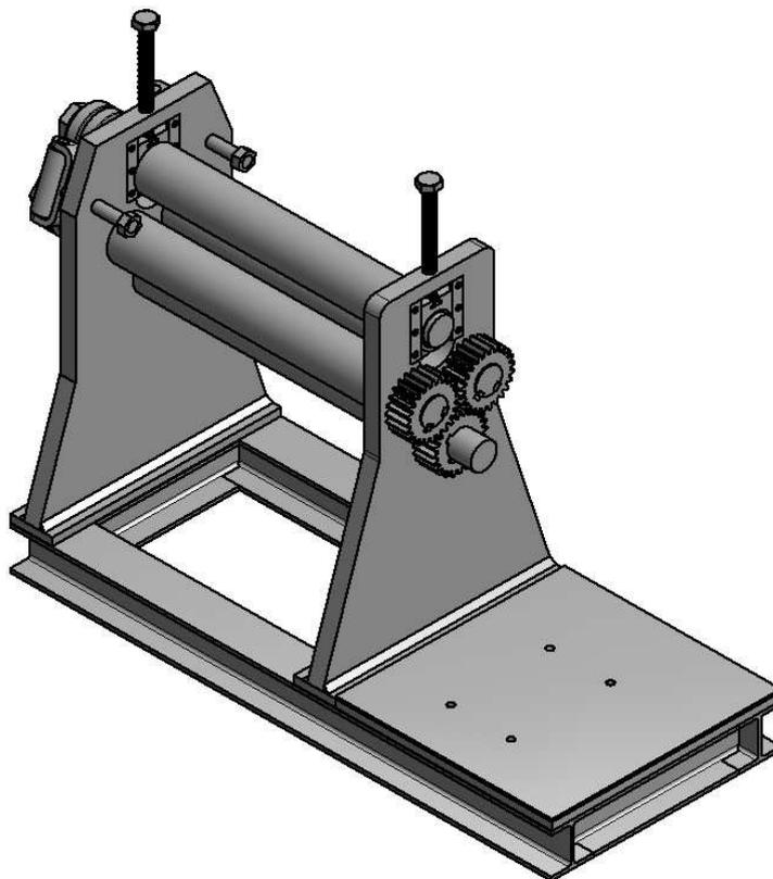
**Bild 2-23 3 Walzen Rundbiegemaschine**
