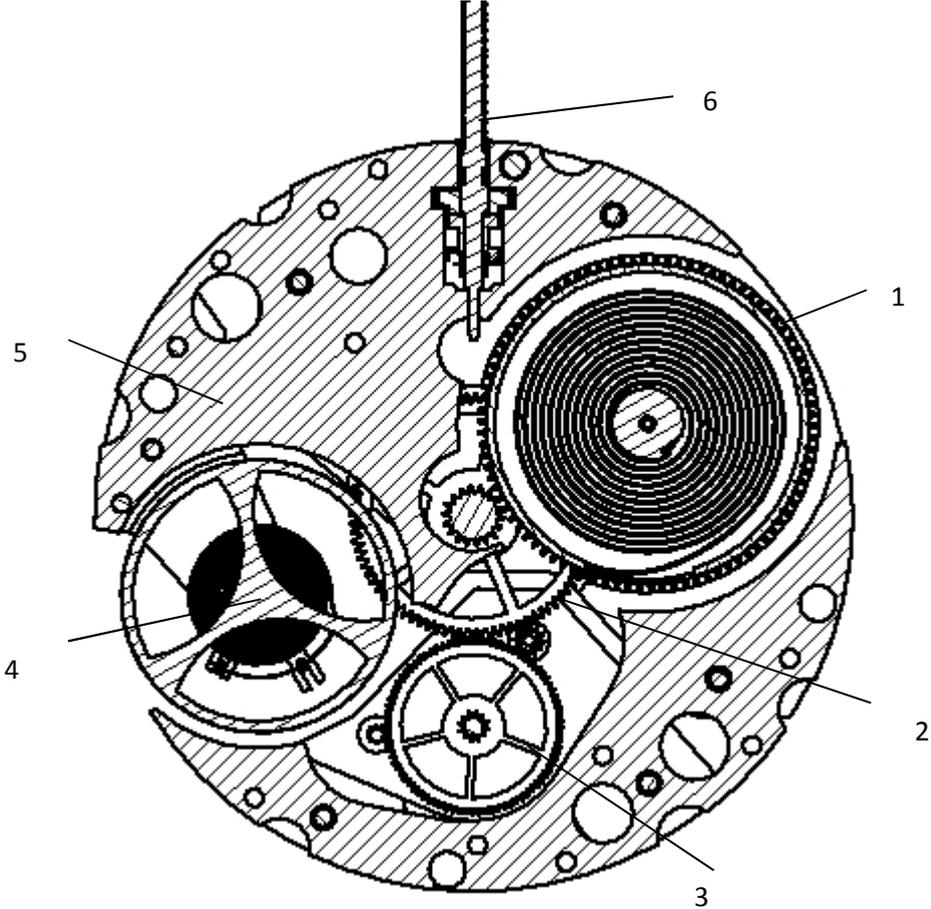
1 Bewegliche Trommel; 2 Mittleres Zahnrad; 3 Zahnrad; 4 Unruhe, Balance; 5 Werkplatte; 6 Stellrad;
